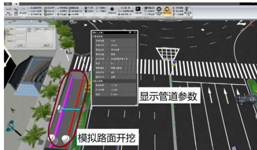
图9 数字沙盘中路面开挖查看隐蔽工程
